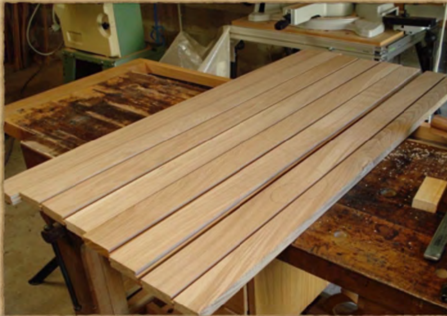
Débit des planches, puis bouvetage
