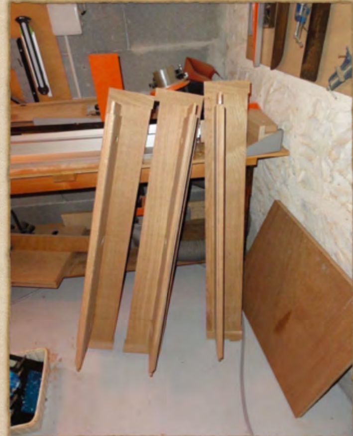
Dessus horizontaux avec les alaises collées pour éviter les déformations et les traverses hautes arrières assemblées pour leur vérification
